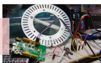
使用Linkit ONE讀取正交編碼器(QEI)的訊號，運算出旋轉方向與轉速，再透過藍芽模組將資料傳輸出去。
